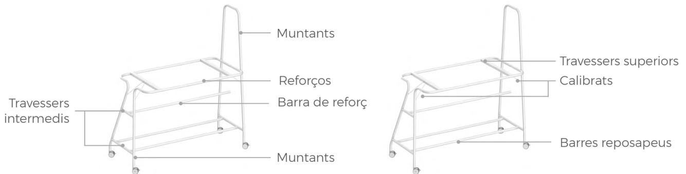
**Laterals** metàl·lics en forma de “V” invertida fabricats en tub corbat d’acer laminat en fred que consta de travessers, muntants i calibrats.
